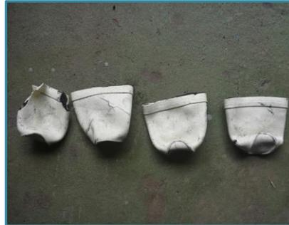
熱と機械的ダメージによる変形が主体
